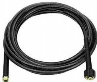
Flexible HP noir 2 tresses acier équipé avec deux raccords à visser. Le flexible noir est plus résistant aux corps gras de type minéral. Le flexible noir présente l'avantage de la souplesse et il est donc moins fragile à l'écrasement. Le principe des raccords démontables manuellement évite l'emploi d'outils.
